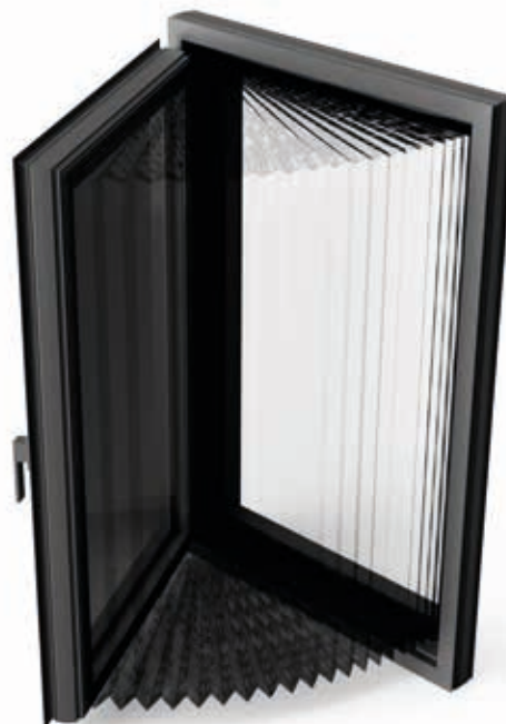
Moskitiera połączona jest magnetycznie ze skrzydłem okna za pomocą ramy z płaskowników aluminiowych wyposażonych w magnesy neodymowe.
